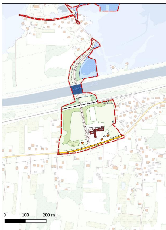
Rysunek 55. Obszary narażone na zalanie w przypadku całkowitego zniszczenia wałów przeciwpowodziowych na podobszarze rewitalizacji 9
