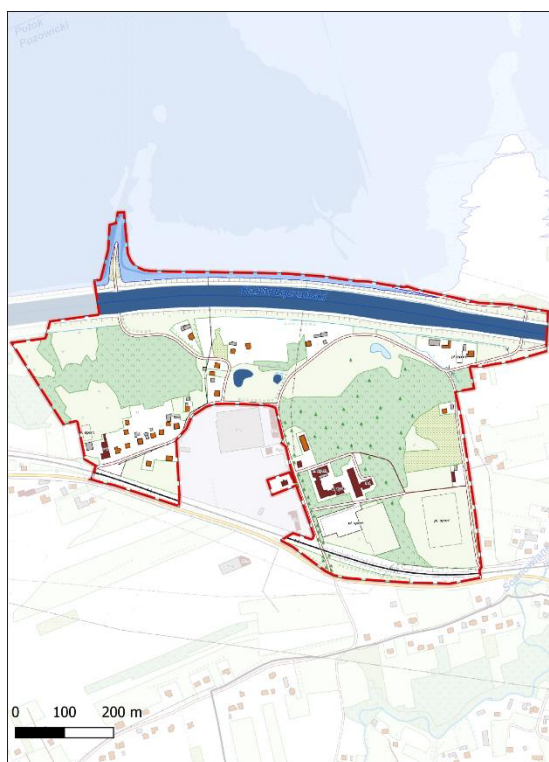
Rysunek 57. Obszary narażone na zalanie w przypadku całkowitego zniszczenia wałów przeciwpowodziowych na podobszarze rewitalizacji 15
